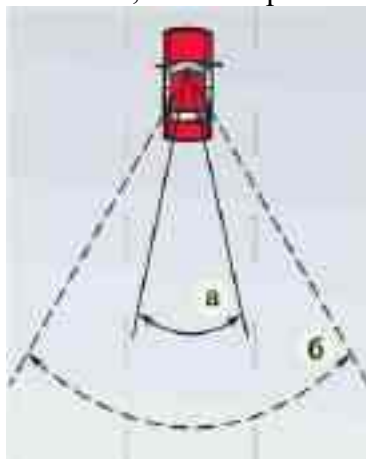
Рис. 6. Зона обзора дороги через: а – плоское зеркало; б – панорамное зеркало
