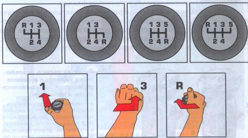
Рис. 3.4. Схемы переключения четырех- и пятиступенчатых коробок передач
