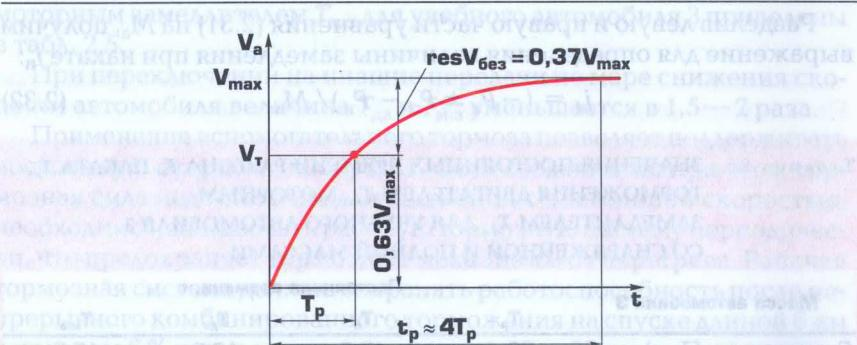
Рис. 2.11. График разгона автомобиля
