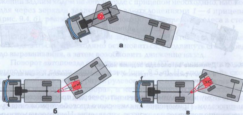
Рис. 9.3. «Складывание» автопоезда:
