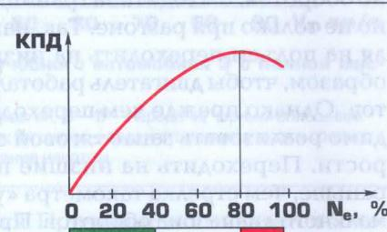
Рис. 3.22. Зависимость КПД двигателя от нагрузки, связь с нагрузкой шкал эконометра:
