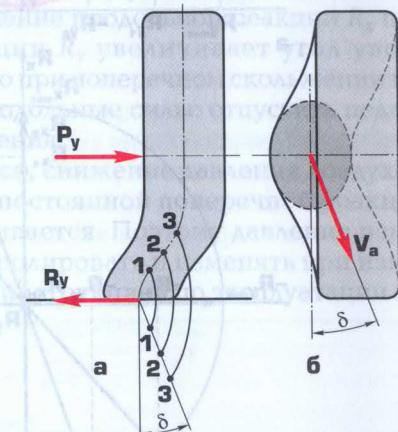
**Рис. 2.8. Схема бокового увода колеса:**
