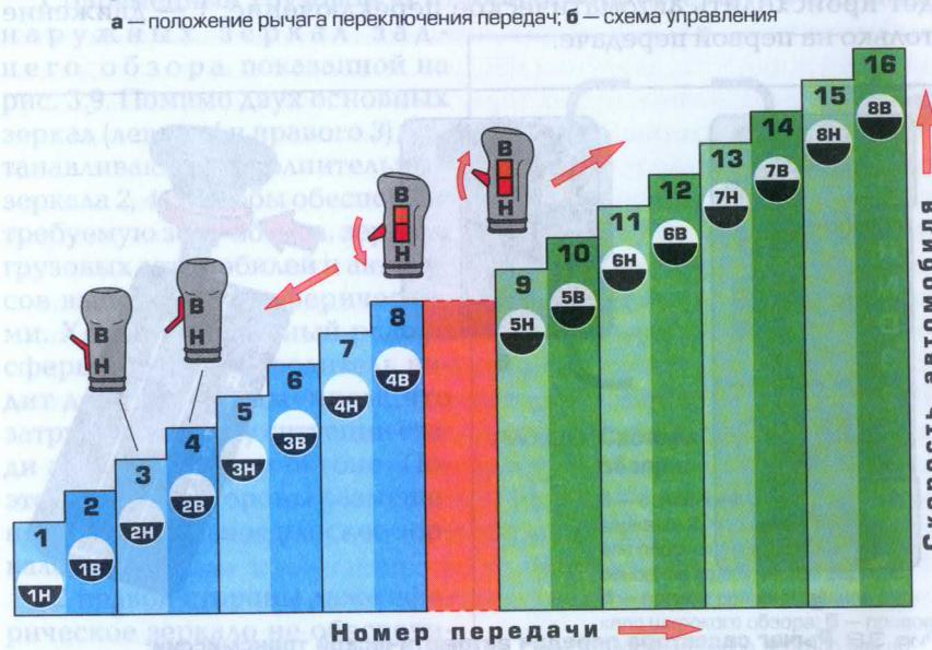
Рис. 3.7. Управление шестнадцатиступенчатой трансмиссией с демультиплексором и делителем
