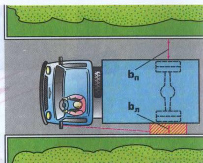
Рис. 4.5. Уменьшение левого интервала  $b_L$  и увеличение правого интервала  $b_R$  в узких проездах
