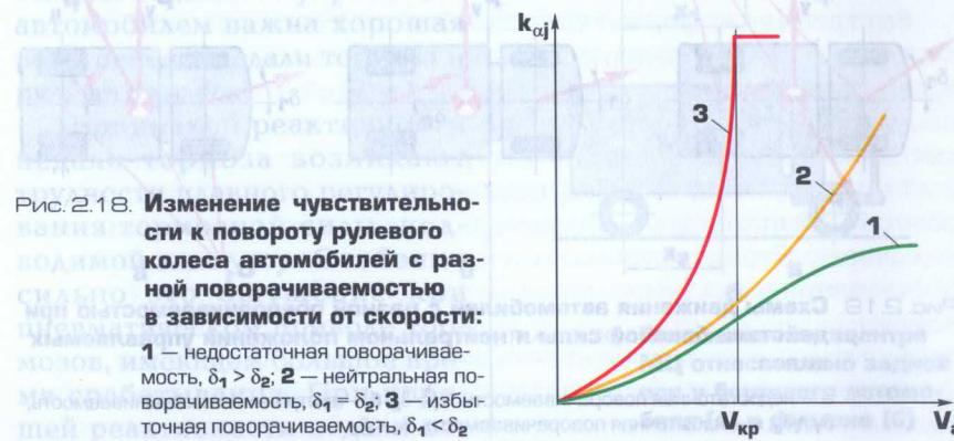
Рис. 2.18. Изменение чувствительности к повороту рулевого колеса автомобилей с разной поворачиваемостью в зависимости от скорости:
