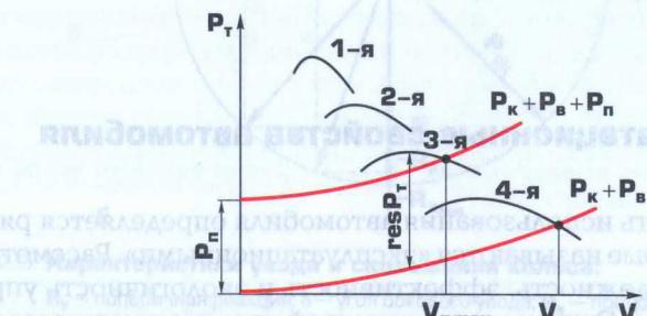
Рис. 2.10. График тягового баланса автомобиля
