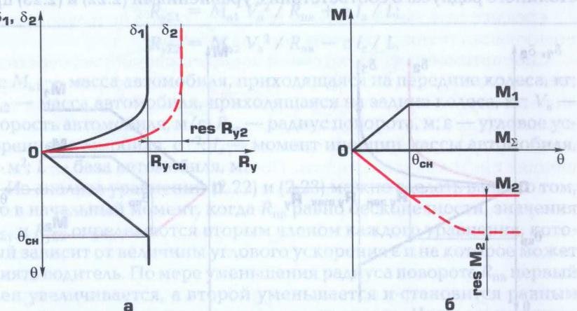
Рис. 5.6. Характеристики курсовой устойчивости автомобиля с недостаточной поворачиваемостью:
