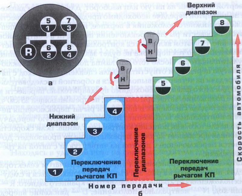
Рис. 3.6. Управление восьмиступенчатой трансмиссией с демультиплексором:
