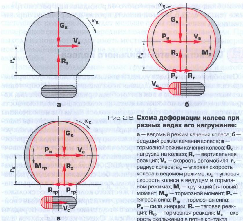
**Рис. 2.6. Схема деформации колеса при разных видах его нагружения:**
