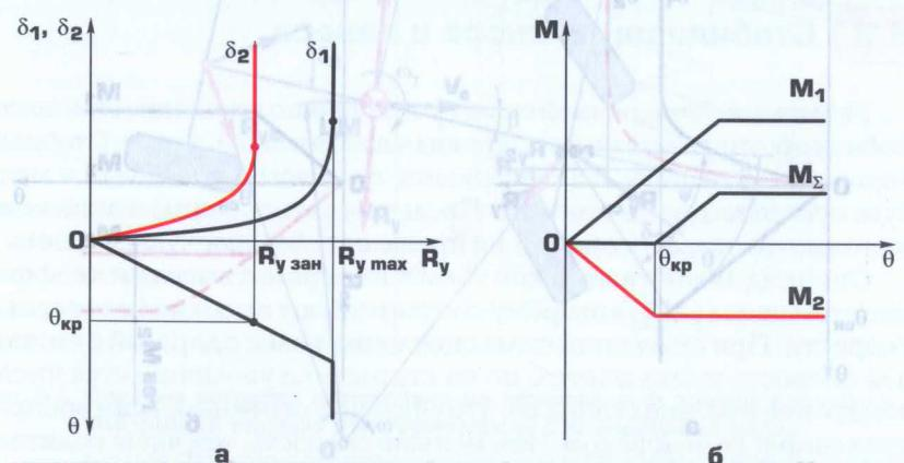
Рис. 5.7. Характеристики курсовой устойчивости автомобиля с избыточной поворачиваемостью:
