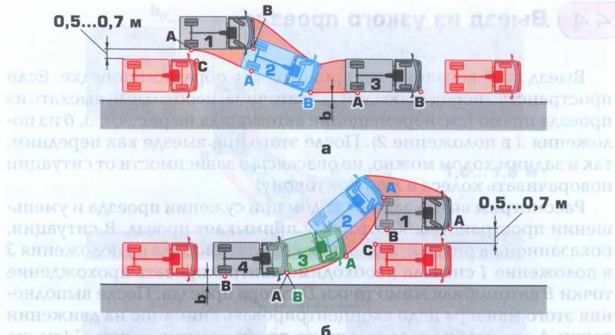
Рис. 4.11. Параллельная парковка:
