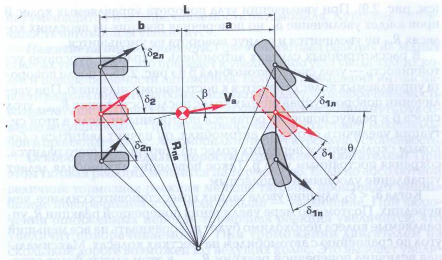
Рис. 2.16. Схема поворота автомобиля с боковым уводом колес
