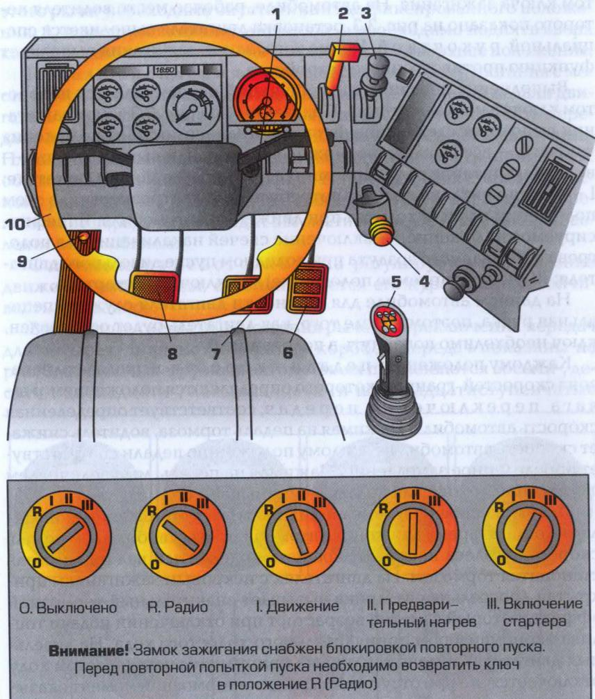
Рис. 3.3. Органы управления грузовым автомобилем и автобусом:
