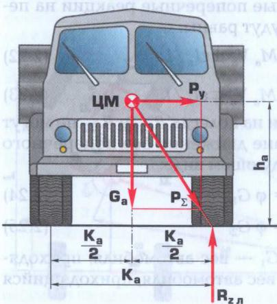
Рис. 2.5. Силы, действующие на автомобиль в момент опрокидывания:
