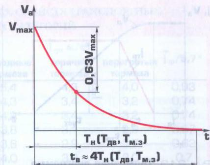
Рис. 2.12. График выбега (движения на катом) автомобиля
