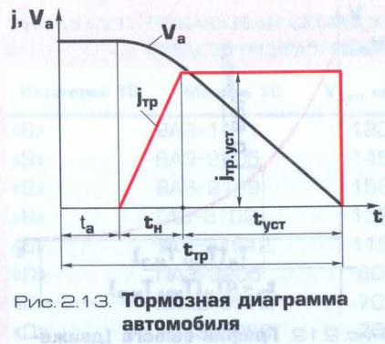
Рис. 2.13. Тормозная диаграмма автомобиля
