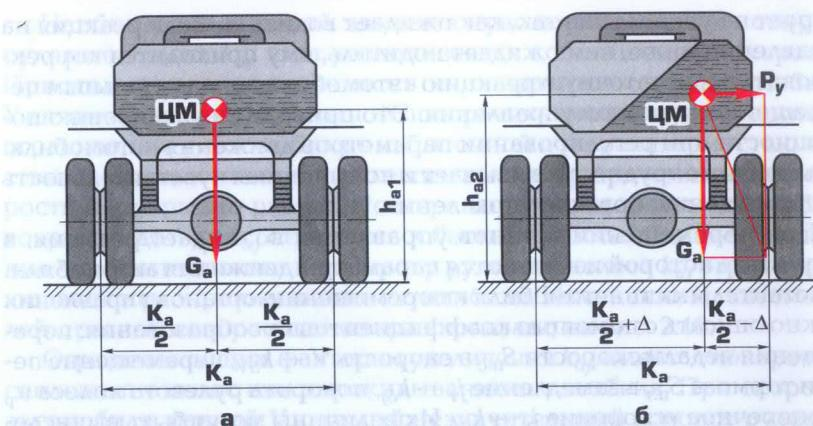
Рис. 2.17. Положение жидкого груза при прямолинейном движении и на повороте
