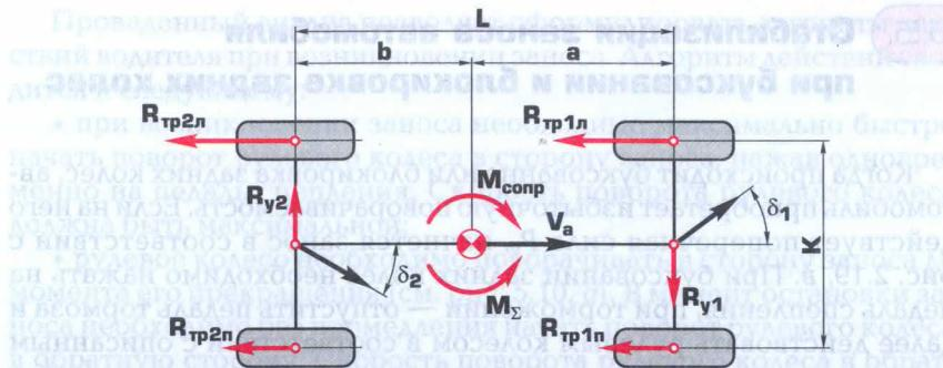
Рис. 5.1.1. Схема движения автомобиля при неравномерном распределении реакций торможения  $R_{\text{tri}}$  по бортам автомобиля:
