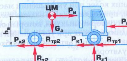
Рис. 2.3. Силы, действующие на автомобиль при торможении:
