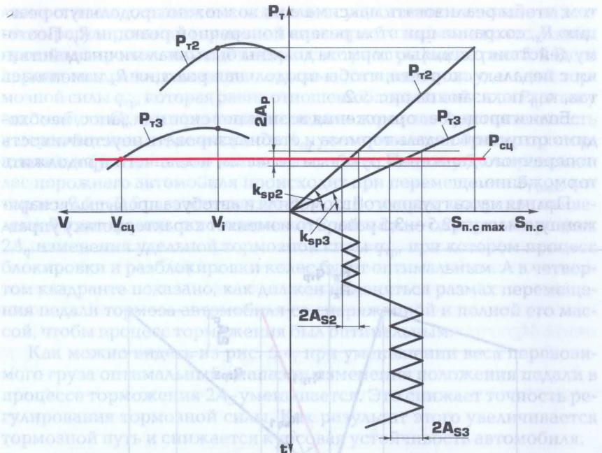
Рис. 5.3. Влияние выбранной передачи на размах перемещения педали скорости  $2A_S$  при движении с буксованием ведущих колес:
