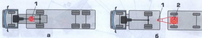
Рис. 9.1. Схема соединения тягача с прицепным составом:
