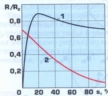
**Рис. 2.7. Изменение относительной продольной  $R_x/R_z$  (1) и поперечной  $R_y/R_z$  (2) реакций в зависимости от коэффициента скольжения  $s$**
