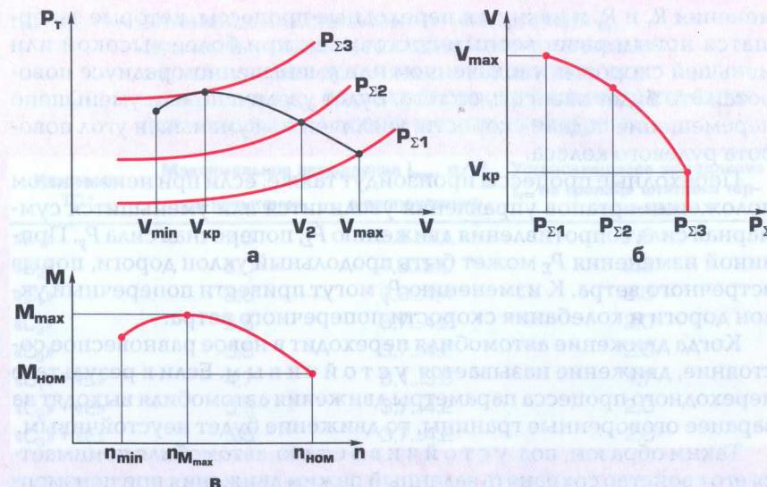
Рис. 2.14. Определение условий устойчивости автомобиля относительно скорости:
