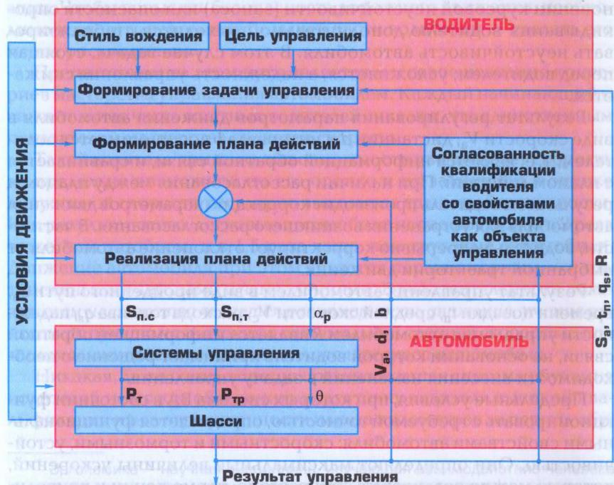
Рис. В.2. Структурная схема системы водитель—автомобиль
