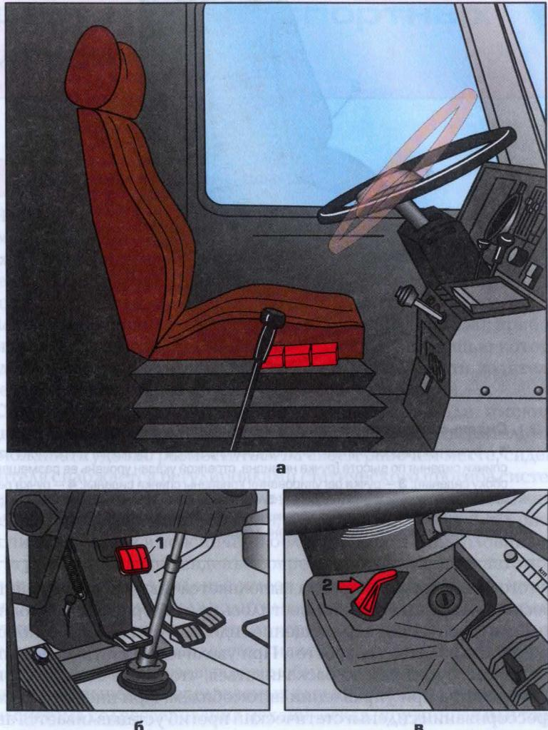
Рис. 3.2. Регулируемое рулевое колесо:
