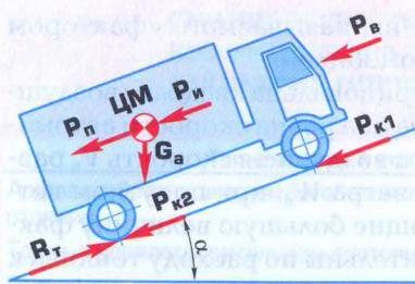
Рис. 2.1. Силы, действующие на автомобиль при движении:
