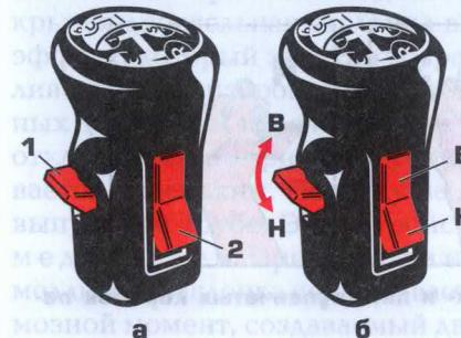
Рис. 3.5. Рукоятка рычага переключения передач с органами управления демультиплексором и делителем:
