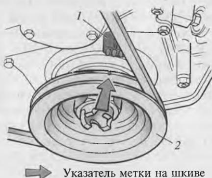
Рис. 16. Метки установки коленчатого вала в ВМТ двигателя ЗМЗ-53:
