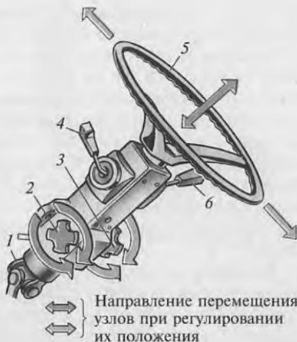
вания по высоте и правый маховичок 3 на  $\frac{1}{4}$  оборота, освободив колонку для регулирования по углу наклона. Затем установить рулевое колесо в нужное положение и повернуть от себя правый маховичок до фиксации колеса по углу наклона, а также левый маховичок. Далее
