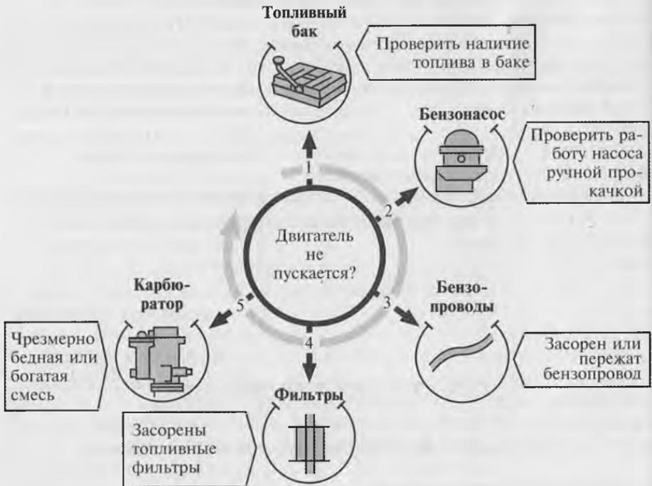
Рис. 49. Проверка работы системы питания:
