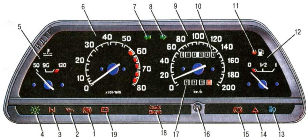
Рис. 3.11. Комбинация приборов: 1 - контрольная лампа включения стояночного тормоза; 2 - контрольная лампа недостаточного давления масла; 3 - контрольная лампа положения воздушной заслонки (только для карбюраторного двигателя); 4 - контрольная лампа включения габаритного света; 5 - указатель температуры охлаждающей жидкости; 6 - тахометр; 7 - контрольная лампа включения левых указателей поворота; 8 - контрольная лампа включения правых указателей поворота; 9 - спидометр; 10 - суммирующий счетчик пройденного пути (одометр);
