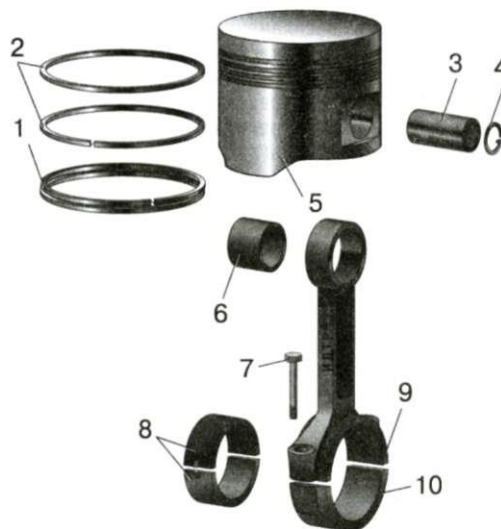
Рис. 2.4. Поршень: 1 - маслосъемное кольцо; 2 - компрессионные кольца; 3 - поршневой палец; 4 - стопорное кольцо; 5 - юбка поршня; 6 - втулка; 7 - болт; 8 - вкладыш; 9 - шатун; 10 - крышка шатуна
