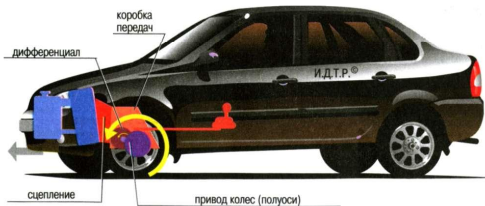
СХЕМА ТРАНСМИССИИ ПЕРЕДНЕПРИВОДНОГО АВТОМОБИЛЯ
